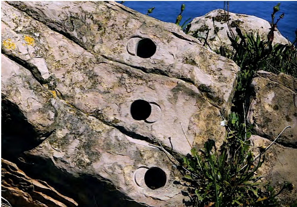
Prélèvement de mini-carottes dans les sédiments du flysch de Zumaia pour l'étude en laboratoire du paléomagnétisme enregistré dans ces roches au moment de leur dépôt. D'après J.Carballo et Asier Hilario, 2010.
